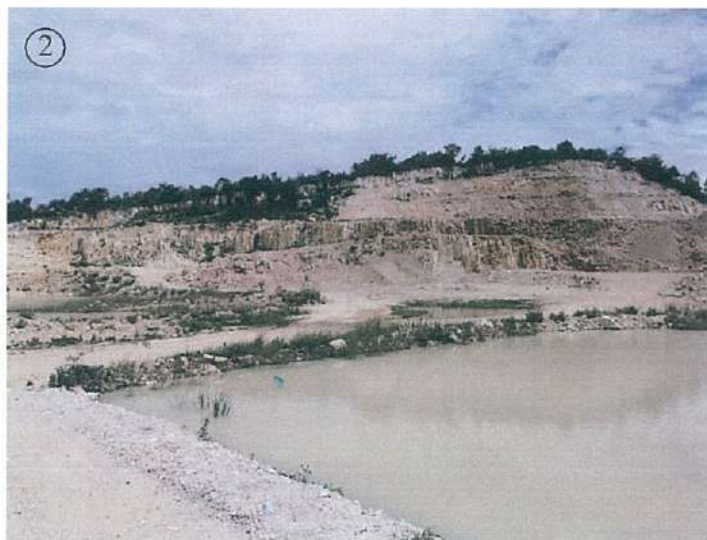
การทำเหมืองแบบขั้นบันได ความสูง Bench 5 เมตร และมีความลาดเอียงไม่เกิน 45 องศา
